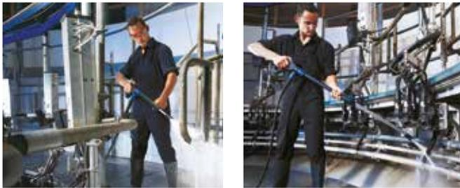
Les solutions HP stationnaires Nilfisk sont incroyablement flexibles. Il est possible, non seulement de travailler à proximité du nettoyeur haute pression, mais aussi à divers endroits dans vos locaux en utilisant un système de canalisations, ce qui permet à un ou plusieurs utilisateurs de nettoyer à distance.
