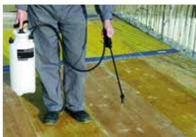
Les pulvérisateurs de liquides sont utilisables manuellement et avec de l'air comprimé (selon version). Certains modèles spécifiques peuvent être utilisés avec des détergents agressifs et des acides.
